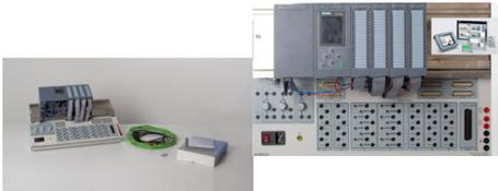
Il est composé d'une unité de base API (773070) et du kit d'entraînement composé de rail, bloc d'alimentation, CPU, entrées numériques, sorties numériques, entrées analogiques, sorties analogiques, câble de connexion Ethernet et logiciel TIA Portal.
