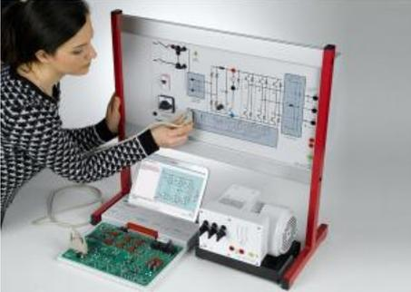
Les cours COM3LAB sur l'électronique de puissance transmettent cette thématique sous une forme concentrée et approfondie. Les courbes caractéristiques des semi-conducteurs de puissance ainsi que les circuits standard de base sont étudiés.
