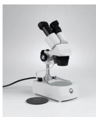
Inclinaison du tube de 45°, grossissement 20x et 40x à l'aide de paires d'objectifs 2x et 4x montés sur système à révolver et oculaires à grand champ 10x, réglage bilatéral, observation possible en lumière incidente, lumière transmisé et par éclairage mixte 20 W grâce à un commutateur rotatif, raccordement secteur 220/230 V.
