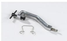
Agrafe d'assemblage pour fixer le joug sur le noyau en U du transformateur d'expérimentation.
