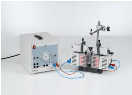
Dans l'expérience P7.3.1.1, on suspend trois tiges de 9 mm de long, de comportement magnétique différent et qu'il est facile de faire tourner, dans un champ magnétique fortement non-homogène de telle façon que ce champ les attire ou les repousse suivant leurs propriétés magnétiques.
