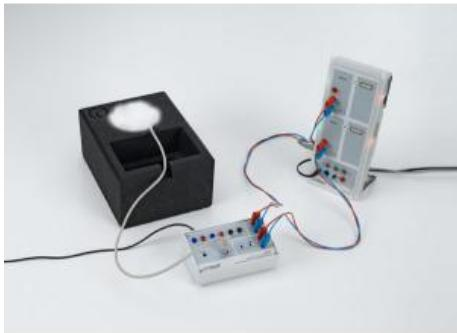
Dans l'expérience P7.2.6.1, on détermine la température critique du supraconducteur à haute température  $YBa_2Cu_3O_7-x$ .
