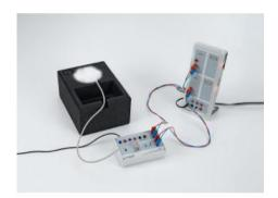
P7.2.6.1 Détermination de la température critique d'un supraconducteur à haute température
