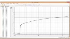
Ce kit permet la détermination exacte de la température de transition ou température critique (mesure en 4 points) à laquelle la résistance électrique du supraconducteur devient nulle.
