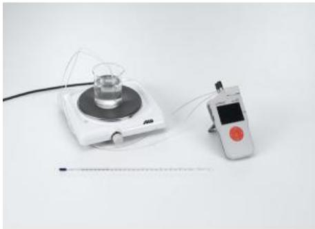
Dans l'expérience P7.2.5.1, on mesure la tension thermique  $U_T$  en fonction de la température  $T$  entre les deux points de contact avec les thermocouples fer-constantan, cuivre-constantan, chrome/nickel constantan.
