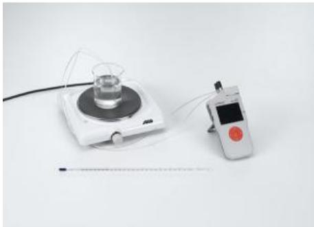
Dans l'expérience P7.2.5.1, on mesure la tension thermique UT en fonction de la température T entre les deux points de contact avec les thermocouples fer-constantan, cuivre-constantan, chrome/nickel constantan.
