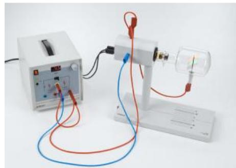
**P7.2.4.1 Excitation de luminescence par exposition à de la lumière ultraviolette et à des électrons**
