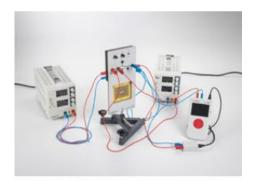
P7.2.1.5 Détermination de l'intervalle d'énergétique entre les deux bandes du germanium
