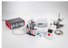
Dans les expériences P7.2.1.1 et P7.2.1.2, on détermine la constante de Hall RH de deux conducteurs électriques par la mesure de la tension de Hall UH en fonction du champ magnétique B pour divers courants I.
