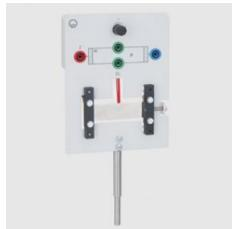
Dans support, avec bande de tungstène fixe, paires de douilles pour branchement électrique et mesure de la tension de Hall ainsi qu'avec un potentiomètre pour le réglage du zéro.
