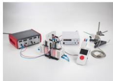
Dans les expériences P7.2.1.1 et P7.2.1.2, on détermine la constante de Hall RH de deux conducteurs électriques par la mesure de la tension de Hall UH en fonction du champ magnétique B pour divers courants I.
