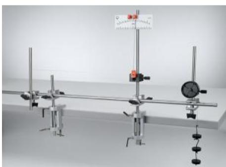
Dans les expériences P7.1.4.1 et P7.1.4.2, on étudie l'allongement d'un fil de fer et d'un fil de cuivre en y accrochant des masses.
