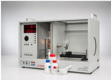
Dans l'expérience P7.1.2.3, des échantillons de fine poudre de cristal micro granulaire sont irradiés avec le rayonnement K $\alpha$  du molybdène afin d'obtenir un film photographique avec la méthode de Debye-Scherrer. Parmi les nombreux cristallites désordonnés, il y a toujours des rayonnements X qui présentent une orientation conforme à la condition de Bragg.
