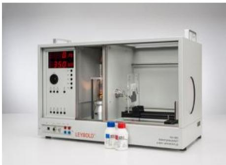
Dans l'expérience P7.1.2.2, le rayonnement de freinage du tube à rayons X joue le rôle de rayonnement X «blanc» afin de réaliser un cliché de Laue des monocristaux de NaCl et de LiF.
