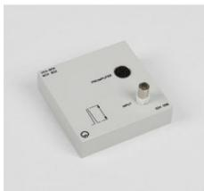
L'adaptateur AMC fait partie du système CASSY ; utilisé avec des détecteurs appropriés (scintillateurs NaJ(Tl), détecteurs semiconducteurs au silicium, par exemple) et en association avec le Sensor-CASSY ( 524 013 ) ou le Pocket-CASSY ( 524 006 , 524 018 ), CASSY Lab ( 524 220 ) et un ordinateur, il joue le rôle d'un analyseur d'impulsions multicanal pour le relevé simple et rapide des spectres de différents produits de désintégration radioactive.
