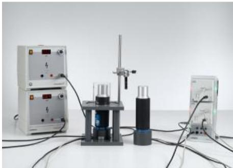
Dans l'expérience P6.5.5.6, on démontre la corrélation spatiale des deux quanta  $\gamma$  pour une désintégration du couple électron-positron.
