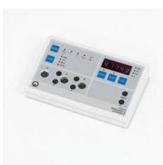
S'utilise en travaux pratiques pour compter les impulsions de tubes compteurs, les taux d'impulsions ou tout autre signal électrique, ainsi que pour mesurer le temps ou la fréquence.
