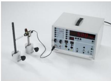
Dans l'expérience P6.4.1.4, on relève la caractéristique courant/ tension dun tube compteur Geiger - Müller. Ici aussi, le courant augmente proportionnellement à la tension lorsque celle-ci est peu élevée et atteint pour des tensions plus importantes une valeur de saturation qui dépend de l'activité ou de l'écartement de la préparation radioactive.
