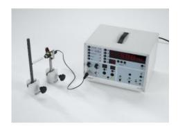
P6.4.1.4 Relevé de la caractéristique d'un tube compteur Geiger-Müller
