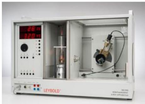
Dans l'expérience P6.3.6.7, on met en évidence la structure fine des raies L d'émission d'une anode en or. Du fait de la fission de tous les niveaux impliqués, on peut observer près de 10 transitions (L<sub>1</sub>-2, L<sub>1</sub>-4, L<sub>1</sub>-3, Li, L<sub>1</sub>), ce qui permet de tirer des conclusions détaillées sur les différents niveaux d'énergie et les transitions possibles.
