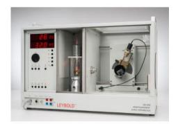
P6.3.6.7 Structure fine du faisceau du caractéristique d'une anode en or
