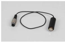
Tube compteur Geiger-Müller à auto-extinction, dans boîtier en plastique, avec fenêtre en mica très mince permettant aussi l'enregistrement d'un rayonnement β mou. Muni d'un câble solidaire. Livré avec capuchon de protection pour la fenêtre en mica.
