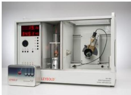
L'expérience P6.3.6.15 consiste à mettre en évidence la structure fine à haute résolution des raies L d'émission d'une anode en tungstène.
