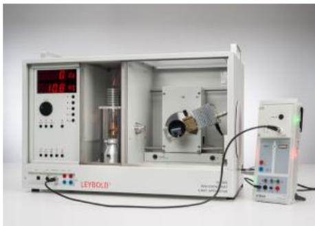
Dans l'expérience P6.3.5.6 on utilise le détecteur d'énergie de rayons X dans la géométrie de Bragg pour observer simultanément les différentes énergies de rayons X, c'est-à-dire l'influence d'énergies sur l'intensité des rayons diffusés.
