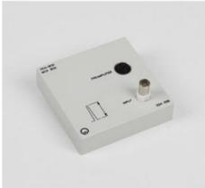
L'adaptateur AMC fait partie du système CASSY ; utilisé avec des détecteurs appropriés (scintillateurs NaJ(Tl), détecteurs semiconducteurs au silicium, par exemple) et en association avec le Sensor-CASSY ( 524 013 ) ou le Pocket-CASSY ( 524 006 , 524 018 ), CASSY Lab ( 524 220 ) et un ordinateur, il joue le rôle d'un analyseur d'impulsions multicanal pour le relevé simple et rapide des spectres de différents produits de désintégration radioactive.
