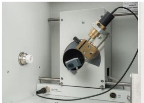
Dans l'expérience P6.3.3.6, on détermine la longueur donde des arêtes d'absorption en fonction du numéro atomique Z.
