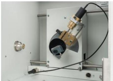
Durant l'expérience P6.3.3.3, on mesure la haute tension  $U$  du tube à rayons X en fonction de la longueur d'onde limite  $\lambda_{\min}$  du spectre continu du rayonnement de freinage.
