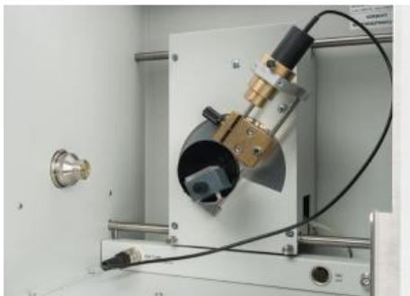
Au cours de l'expérience P6.3.3.1, on étudie la diffraction par un monocristal de NaCl des raies caractéristiques K $\alpha$  et K $\beta$  de l'anode en molybdène pour vérifier la nature ondulatoire des rayons X. Cette diffraction s'explique par la loi de la réflexion de Bragg.
