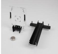
Pour l'appareil à rayons X ( 554 800 et 554 801 ), avec échelle sériographiée pour le positionnement défini des films pour les radioscopies, les clichés de Laue et de Debye-Scherrer ; livré avec rail d'expérimentation à échelle graduée en millimètres et diaphragme à trou (D = 1 mm) à placer sur le collimateur à fente.
