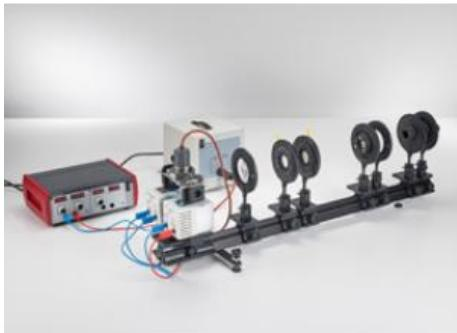
Durant l'expérience P6.2.7.3, on observe l'effet Zeeman sur la raie rouge du cadmium perpendiculairement et parallèlement au champ magnétique puis on détermine l'état de polarisation des diverses composantes Zeeman. Les observations sont expliquées avec la caractéristique de rayonnement d'une radiation de dipôle.
