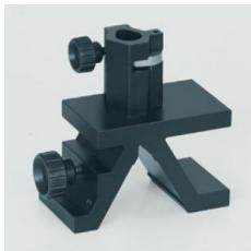
Cavalier pour banc d'optique à profil normalisé.
