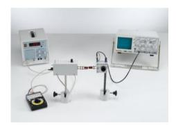
P6.2.6.3 Absorption résonnante d'un circuit oscillant de haute fréquence (HF) passif
