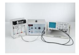
P6.2.4.3 Expérience de Franck-Hertz avec le néon -Tracé avec l'oscilloscope
