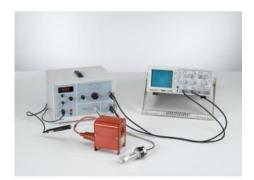
P6.2.4.1 Expérience de Franck-Hertz avec le mercure -Tracé avec l'oscilloscope
