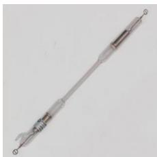
Pour observer les spectres d'émission du néon, décharge de gaz dans des tubes capillaires. Raccords adaptés aux supports pour tubes spectraux. ( 467 81 ).
