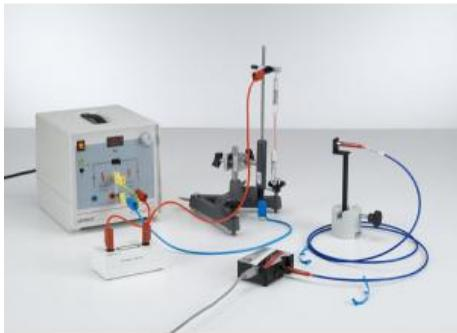
Dans l'expérience P6.2.2.6, l'émission des spectres des lampes à décharge de gaz est étudié à l'aide d'un spectromètre compact et facile à manier.
