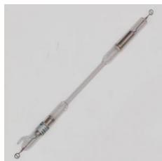
Pour observer des spectres d'émission de mercure (avec Ar), décharge de gaz dans des tubes capillaires. Raccords adaptés aux supports pour tubes spectraux ( 467 81 ).
