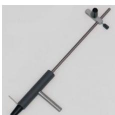
Avec un anneau fixe et l'autre ajustable pour la fixation des tubes ( 46763 -70), livré avec tige.
