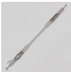
Pour observer les spectres d'émission d'hélium, décharge de gaz dans des tubes capillaires. Raccords adaptés aux supports pour tubes spectraux ( 467 81 ).
