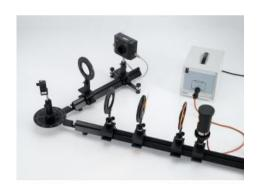
Dans l'expérience P6.2.2.3, les raies spectrales d'une lampe à vapeur de mercure haute pression sont étudiées à l'aide d'un montage de spectre à haute résolution.
