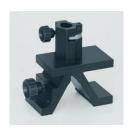
Cavalier pour banc d'optique à profil normalisé. Pour démonstrations et expériences en laboratoire de haute précision. Profilé d'aluminium anodisé noir, traité mécaniquement pour une grande précision.
