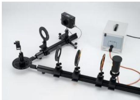
Dans l'expérience P6.2.2.3, les raies spectrales d'une lampe à vapeur de mercure haute pression sont étudiées à l'aide d'un montage de spectre à haute résolution.
