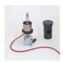
Pour la fixation et le branchement des lampes spectrales (451011 -111) à la bobine de self universelle (45130). Avec dispositif d'amorçage intégré, ouvertures pour le refroidissement et tige.
