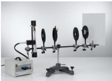
Au cours de l'expérience P6.2.1.1, une lampe de Balmer remplie de vapeur d'eau sert à l'excitation du spectre d'émission.
