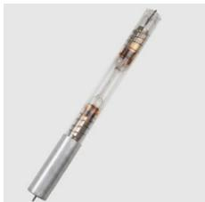
Pour l'observation et l'analyse du spectre de l'hydrogène (série de Balmer).
