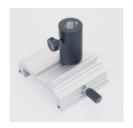
Support de fixation des lampes (450 60) et (450 64) ainsi que de l'écran (441 53) sur un banc d'optique à profil S1 (460 310/317).
