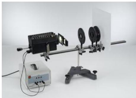
Dans l'expérience P6.1.5.2, on illustre la méthode de Debye et Scherrer appliquée à un tube pour la diffraction délectrons avec de la lumière visible.
