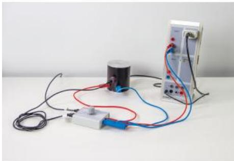
Dans l'expérience P6.1.4.6, la lumière de différentes diodes électroluminescentes colorée brille l'une après l'autre sur la photocathode d'une cellule photoélectrique à vide.
