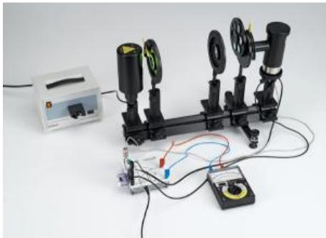
Durant l'expérience P6.1.4.3, on utilise la méthode du condensateur pour produire la tension inverse U entre la cathode et l'anode de la cellule photoélectrique.
