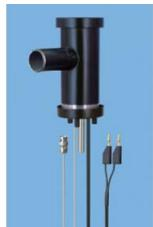
Boîtier étanche à la lumière pour cellule photo-électrique sur tige, avec diaphragme circulaire et tube amovible.
