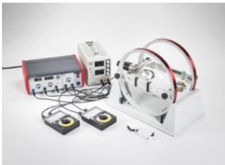
Au cours de l'expérience P6.1.3.1, pour déterminer la charge spécifique de l'électron, un fin jet électronique concentré est dévié dans un champ magnétique homogène, suivant ainsi une trajectoire circulaire fermée. On détermine en fonction de la tension accélératrice  $U$  et du champ magnétique  $B$  la force les électrons à suivre cette trajectoire de rayonné.
