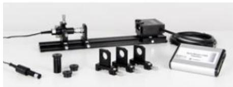
Dans l'expérience P5.8.8.6, on utilise deux lasers différents qui émettent dans le domaine du visible, avec en plus des optiques de collimation et de dilatation afin d'effectuer diverses mesures du profil d'un faisceau pour différents types de faisceaux et ainsi montrer les possibilités de profilage d'un faisceau laser.
