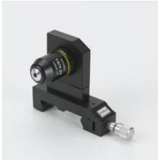
Le collimateur est constitué d'un objectif de microscope, il forme un rayon laser à partir de la lumière émise par une diode laser ou une fibre optique ou inversement, réinjecte un rayon laser dans une fibre optique. L'objectif est dans une monture clipsable sur cavalier permettant le montage sur le banc d'optique.
