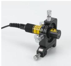
Diode laser sans autre composant optique, montée sur un support basculable et pouvant être déplacé transversalement. Il est possible de réguler la température et le courant laser de la diode laser(300 mW pour 808 nm) grâce à un élément Peltier associé à l'unité de commande ( 474302 ) afin de varier la longueur d'onde et l'intensité. Le support permet un ajustage facile sur le banc d'optique. Sans autre composant optique, la diode émet un cône lumineux très divergent.
