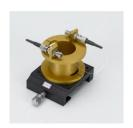
Ce module est la pièce maîtresse de l'installation et l'un des composants les plus précieux. Il se compose de 16 m de fibre dopée à l'erbium, enroulée sur un tambour. Les extrémités de la fibre sont reliées à des connecteurs ST qui sont eux-mêmes reliés à la prise de fibre.
