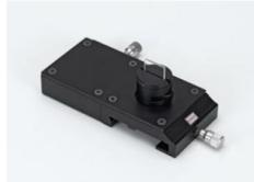
Le module de couplage de sortie est utilisé entre les deux collimateurs à fibre (474 191, 474 192).
