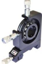
Support ajustable avec insert tournant qui permet de faire tourner le laser utilisé de façon définie autour de son axe longitudinal.
