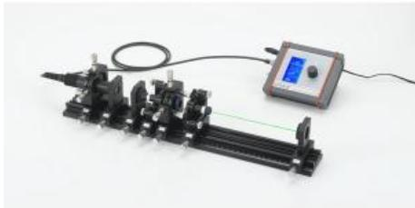
L'expérience P5.8.6.3 consiste à optimiser la configuration de base du laser Nd:YAG pompé par diode (P5.8.6.2) avec un module cristal KTP placé dans la cavité laser pour ainsi générer une lumière verte et visible (532 nm), doublée en fréquence.
