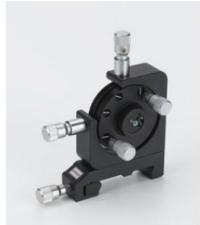
Cristal à propriétés optiques non linéaires dans support. Il permet le doublage de fréquence intra-cavité à 532 nm (vert) de la longueur d'onde infrarouge 1064 nm d'un laser Nd:YAG. Le cristal peut être basculé et déplacé respectivement sur deux axes ainsi que tourné sur l'axe longitudinal afin d'atteindre l'accord de phase. Traité antireflet des deux côtés pour 1064 nm et 532 nm.
