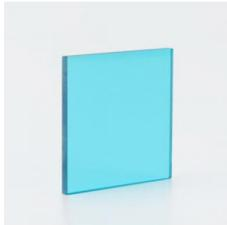
Le filtre de lumière vert BG39 bloque le rayonnement d'un laser (de pompage) au-dessus de 800 nm et laisse de rayonnement visible à 532 nm par avec 80% efficiency. Le filtre est utilisé dans un diode laser à semi-conducteurs pour séparer le second harmonique à 532 nm du rayonnement laser et de la pompe.
