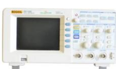
Oscilloscope numérique, opération facile à utiliser.
