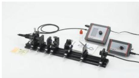
Dans l'expérience P5.8.6.2, il s'agit de réaliser un laser Nd:YAG pompé par une diode laser.
