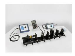
Le but de l'expérience P5.8.6.1 est d'étudier les propriétés d'une diode laser, à savoir ses paramètres caractéristiques comme la puissance et la longueur d'onde d'émission en fonction de la température. Dans une prochaine étape, on mesure la répartition spatiale de l'intensité.
