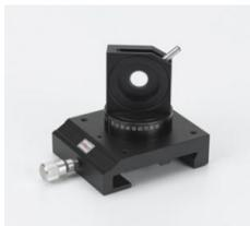
Un disque en quartz cristallin biréfringent dans un support tournant sur deux axes, similaire au filtre de Lyot. Dans le résonateur laser hélium-néon, ce filtre permet de bloquer la raie 632 nm et de laisser agir les raies de plus faible intensité.
