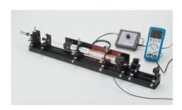
L'expérience P5.8.5.5 consiste à réaliser un laser hélium-néon constitué des éléments de base.
