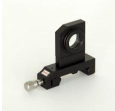
Lentille biconvexe (f = 150 mm) dans support avec cavalier.
