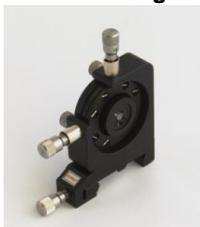
Lentille biconcave à courte focale ( $f = -5 \text{ mm}$ ) dans support ajustable, pour élargir un faisceau laser.
