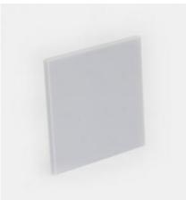
Plaque diffusante en matière plastique à utiliser par exemple avec le bras pivotant ( 474121 ) pour étudier la diffusion de la lumière en fonction de l'angle.
