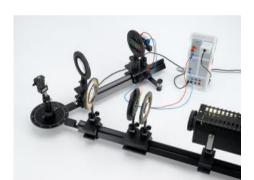
P5.7.2.5 Détermination du spectre d'une lampe xénon à l'aide d'un réseau holographique
