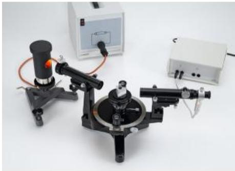
Dans l'expérience P5.7.1.1, on observe les raies spectrales de gaz rares et de vapeurs métalliques excités. Pour identifier les raies spectrales dans un premier temps «inconnues», on mesure leurs angles de déviation et on procède à la conversion en la longueur donde correspondante au moyen de la courbe de calibrage.
