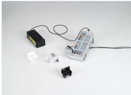
Dans l'expérience P5.6.3.4 on place de l'eau et du plexiglas d'épaisseur  $d$  dans la marche des rayons pour ensuite mesurer l'augmentation du temps de propagation ainsi obtenue.
